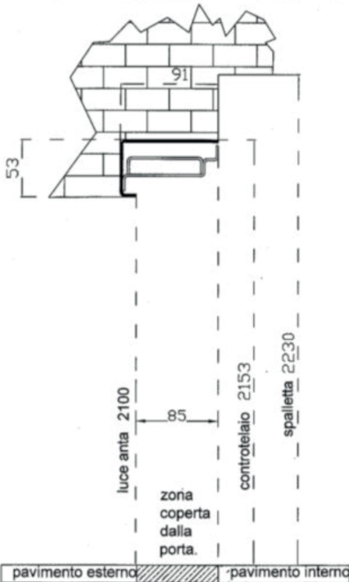
NOTE: SUI LATI DEL CONTROTELAIO CI SONO 2 SCATOLE PER LATO IN CORRISPONDENZA DELLA CERNIERA CHE OCCUPANO 2 cm IN LARGHEZZA E 10,5 cm IN ALTEZZA. POSIZIONE CENTRO SCATOLA DA TERRA H 195 E H 1900
